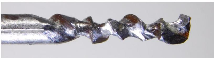
Рис. 20. Фреза прерывистый гребень
