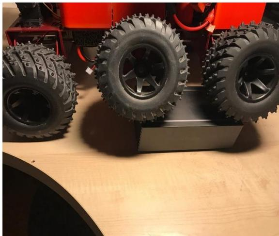
Платформа состоит из алюминиевой шестиколёсной(6x6) платформы. На каждом колесе стоит свой независимый коллекторный двигатель. Помимо этого, платформа снабжена независимой пружинной
