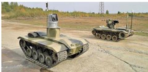
Боевая и разведывательная машины российского робототехнического комплекса «Нерехта»
