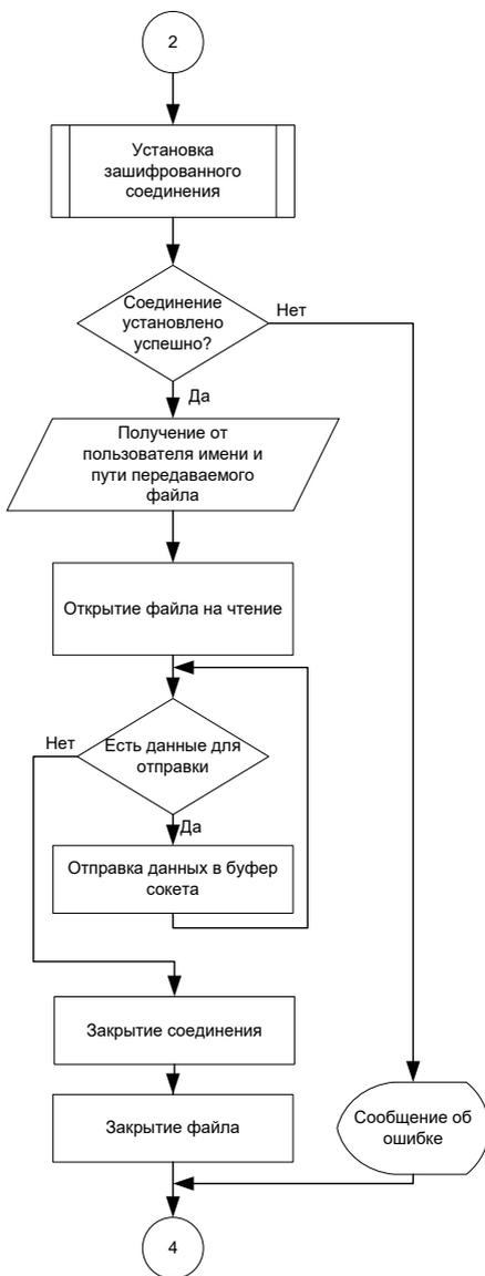
Рисунок 12 – Алгоритм передачи файлов
