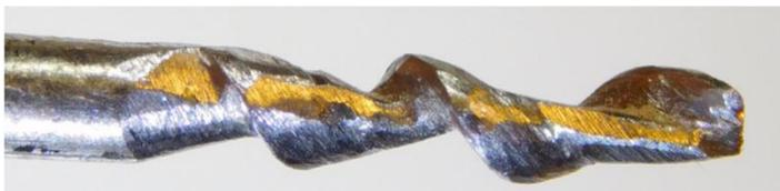
Рис. 19. Фреза спираль с наибольшим шагом режущей кромки
