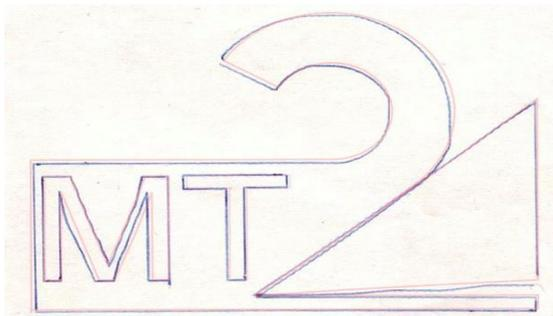
Рис. 23. Чертеж логотипа кафедры МТ2: красная линия – исходный рисунок, синяя линия – результат работы станка
