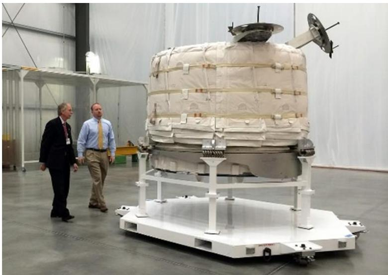
Рис.2. Космический модуль BEAM в сложенном виде
