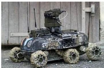
Легкий разведывательный колесный робот Foxbot (Германия)
