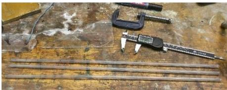
Штанги были изготовлены из пластиковой трубки диаметром 8мм
