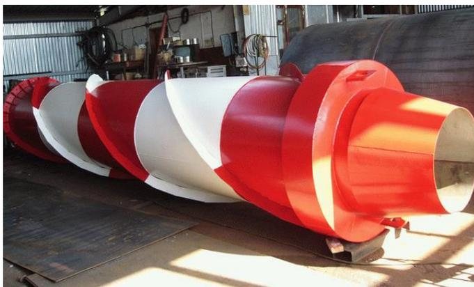
Рисунок 13 – Интерцепторы на корпусе дымовой трубы
