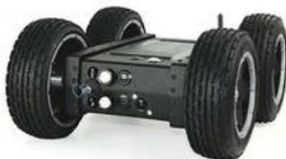
Малогабаритный колесный робот Arthron POD 125A (Франция)
