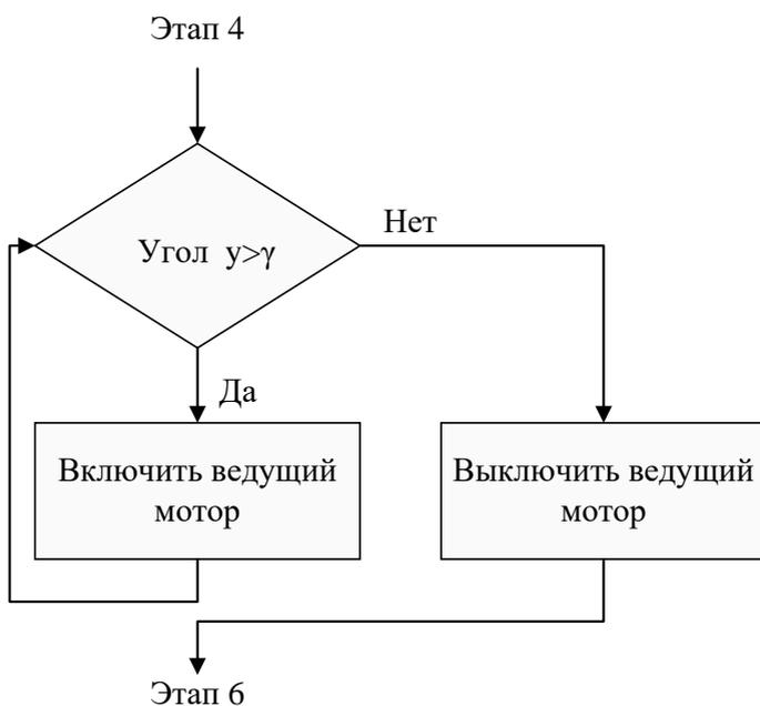
Рис. 15. Блок – схема этапа 5
