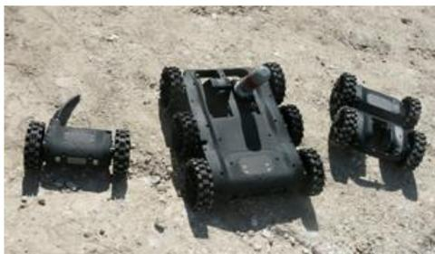
Линейка колесных малогабаритных роботов Nerva (Франция)
