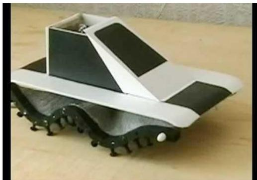
**Двигатель типа «Аэрол» с подвижными пневмокатками**
