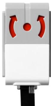
Рис. 28. Гироскопический датчик
