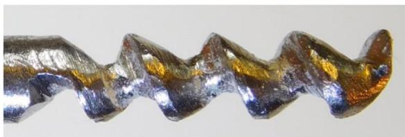
Рис. 18. Фреза спираль с уменьшенным шагом спиральной
