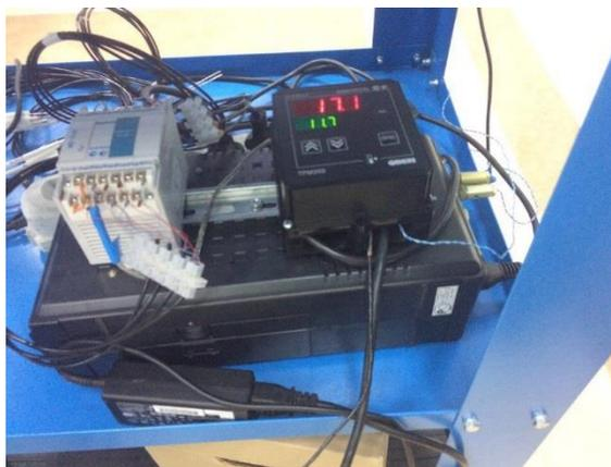
Рис.3 Измеритель двухканальный TRM 200
