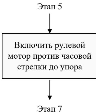
Рис. 16. Блок – схема этапа 6
