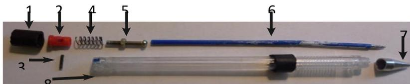
Рис. 6. Ручка для плоттера: 1 – резиновая трубка, 2 – заглушка, 3 – штифт, 4 – пружина, 5 – винт с гайкой, 6 – стержень, 7 – наконечник, 8 – корпус
