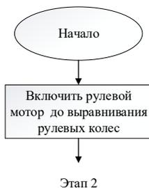
Рис. 10. Блок – схема этапа 1
