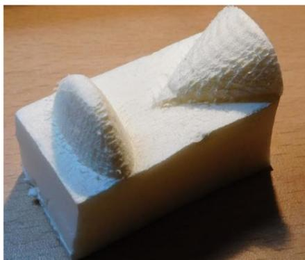
Рис. 25. Чертежи поверхностей, построенные в программе Inventor и выфрезерованные на станке
